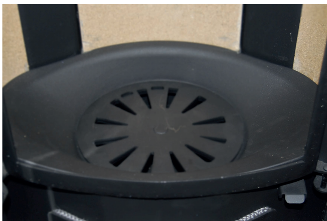
Figur 2. Skyv asken gjennom fyrristen til skuffen under
